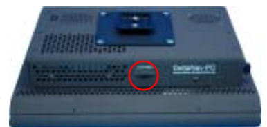
Potentiometer und Lichtsensor für LCD Hintergrundbeleuchtung
