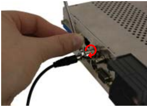
Überwurfmutter mit Gabelschlüssel anziehen
