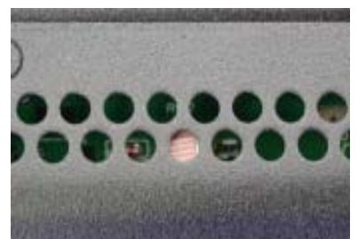
Autom. Helligkeitsregelung mit Lichtsensor
